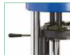
▲ LEVA SICUREZZA MORSETTI SAFETY DIES LEVER
