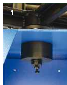
▲ FRENO MECCANICO SBOBINATORE REEL ROLLER MECHANICAL BRAKE
