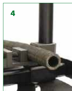
▲ BLOCCA TUBO REGOLABILE ADJUSTABLE HOSE LOCKER
