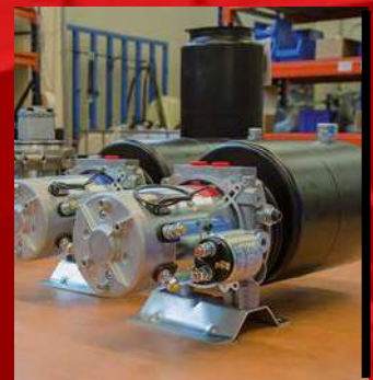
MONTAJE DE MINICENTRAL POWERPACK ASSEMBLY
