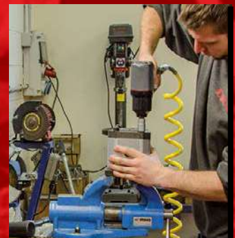
MONTAJE BOMBAS HIDRÁULICAS HYDRAULIC PUMP ASSEMBLY
